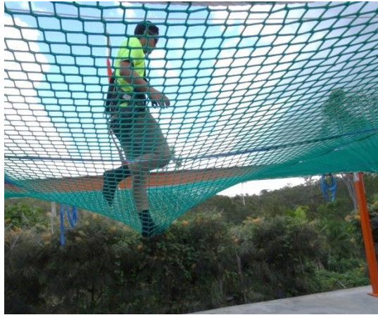
Şekil 13: Yük sonucu esneme
